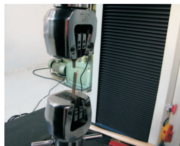
Rys. 6. Próba statycznego rozciągania próbek stalowych
