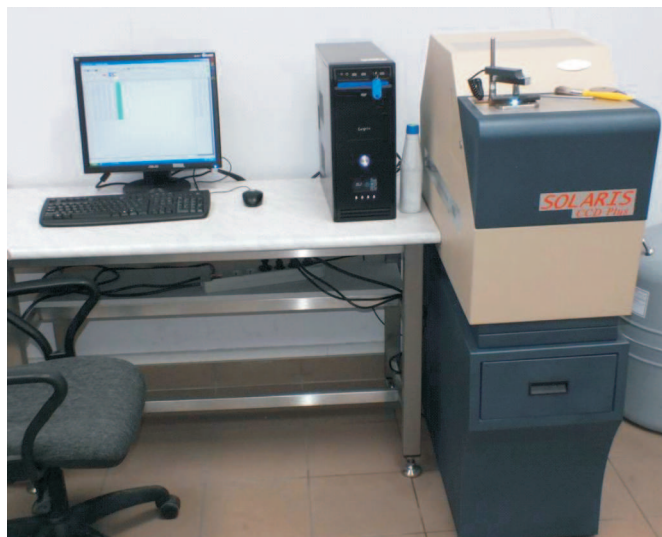
Rys. 4. Analizator składu chemicznego stali SOLARIS CCD Plus
