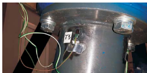
Rys. 3. Czujniki tensometryczne rejestrujące naprężenia elementów roboczych
