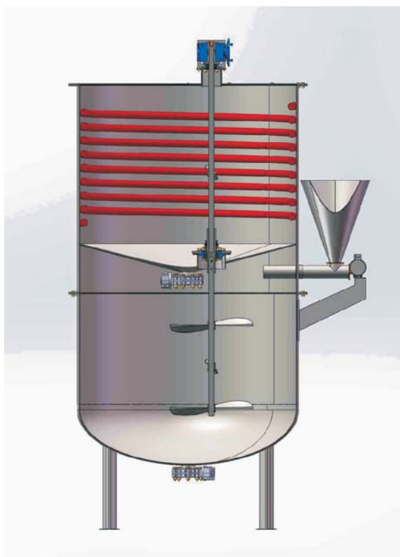
Rys. 1. Przekrój modelu zbiornika rafinacyjnego oleju Fig. 1. The cross section of refining tank of oil
