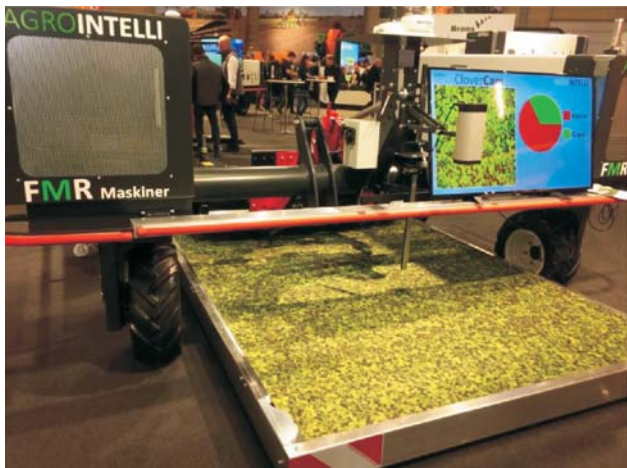
Rys. 2. System CloverCam zamontowany na autonomicznym robocie Robotti firmy AGROINTELLI podczas targów Agromek 2018
