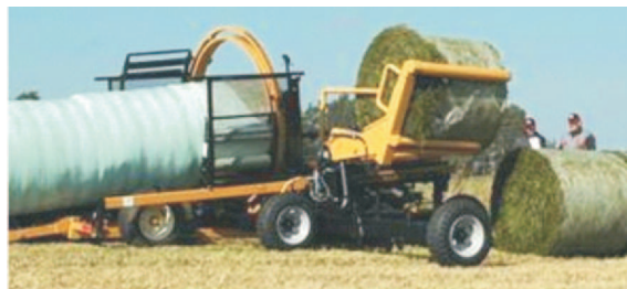
Rys. 3. Owijarka firmy Tubeline Manufacturing z zespołem samoładowniczym NHK FastLift
