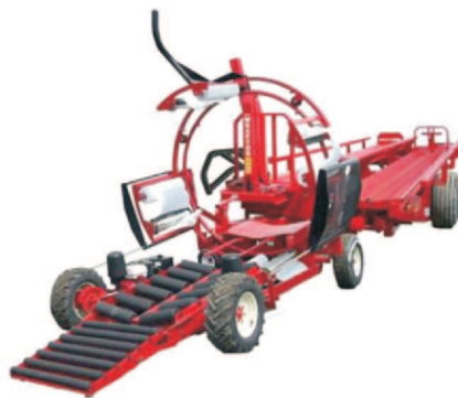
Rys. 2. Maszyna do grupowego owijania bel cylindrycznych Wraptor Combo System firmy Anderson
