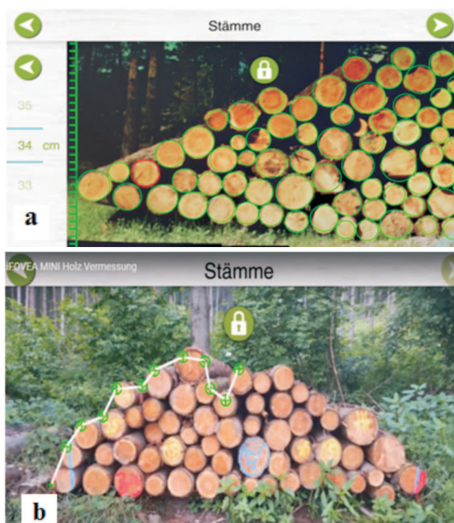
Rys. 1. Etapy pomiaru stosu za pomocą aplikacji iFOVEA: a - identyfikowanie i pomiar przekroju kłód, b - zaznaczanie obrysu zewnętrznego stosu
