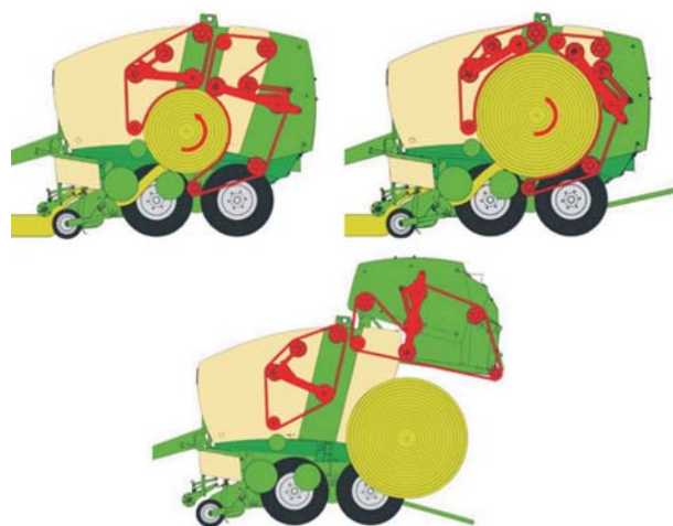
Rys. 9. Zasada działania prasy zwijającej Fortima firmy KRONE ze zmienną komorą prasowania [7]
