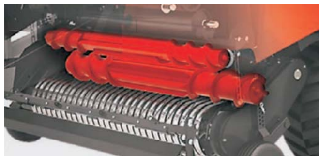
Rys. 2. Otwarty zespół podający OptiFlow firmy KUHN [7]
