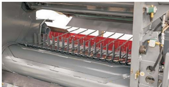
Rys. 1. Podajnik widłowy w prasie zwijającej DF 2,1 CC firmy UNIA GROUP [7]
