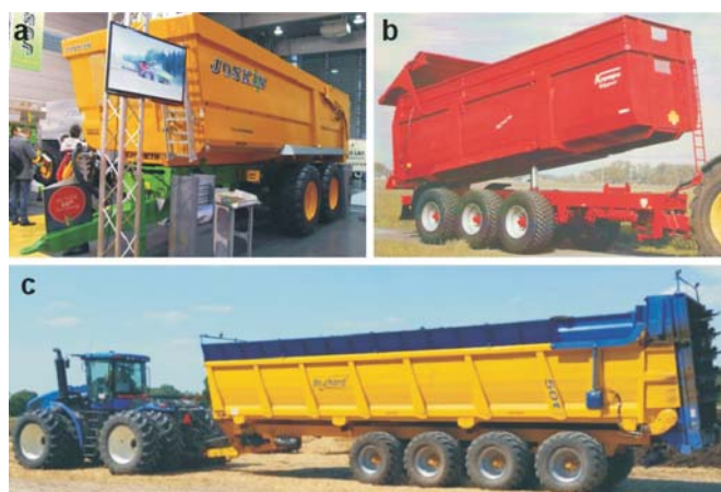
Rys. 1. Zespoły jezdne środków transportowych [5]: a) tandem Joskin Trans-CAP 6500/22BC150 [3], b) tridem Krampe Kipper BigBody 800 [4], c) quattro Brochard o ładowności 50t [4]
