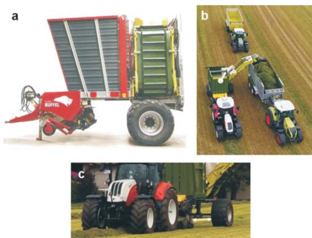
Rys. 5. Przyczepa zbierająco-ładująca Buffel firmy Fliegl [5]: a) konstrukcja, b) technologia zbioru, c) rozsuwana oś Fig. 5. The self-loading trailer of Fliegl [5]: a) construction, b) harvest technology, c) move axle system
