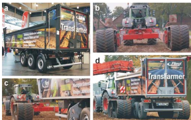
Rys. 3. Zmiana układu jezdny w przyczepie TransFarmer [5] Fig. 3. Change of driving system in trailer TransFarmer [5]
