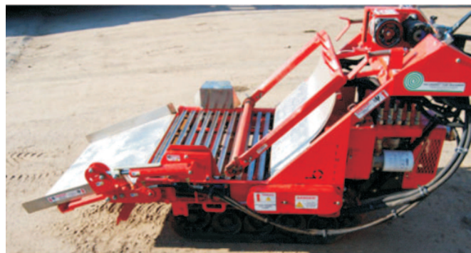
Rys. 7. Urządzenie do układania darni z napędem silnikowym i gąsienicowym układem jezdnym [9] Fig. 7. The apparatus for laying turf with engine drive and crawler chassis [9]
