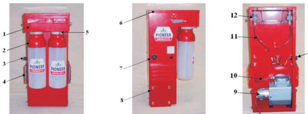
Rys. 3. Aplikator Appli Pro SLV [3]: 1 - mocowanie pojemnika, 2 - pojemnik z preparatem zakiszującym, 3, 7 - złącze elektryczne, 4 - filtr powietrza, 5 - odpowietrznik, 6 - pokrywa, 8 - wspornik, 9 - sprężarka, 10 - przewód powietrzny, 11 - przewód środka konserwującego, 12 - zawór
