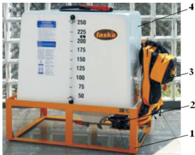
Rys. 2. Aplikator Faska FAAP 240 [3]: 1 - rama, 2 - pompa rotacyjna, 3 - zasobnik na elementy oprzyrządowania, 4 - zbiornik Fig. 2. Applicator Faska FAAP 240 [3]: 1 - frame, 2 - rotary pump, 3 - tray tooling components, 4 - container
