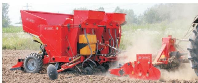
Rys. 3. Wieloczynnościowy agregat do sadzenia ziemniaków podczas pracy Fig. 3. Universal unit to plant potatoes during the work
