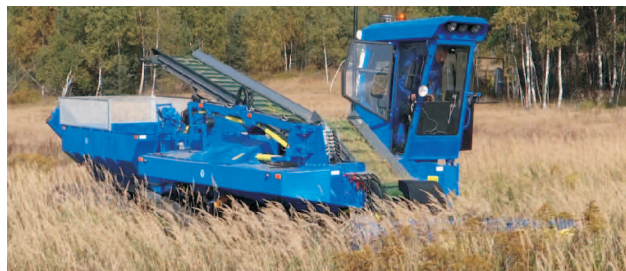
Rys. 5. Wielomodułowa samobieźna maszyna do ochrony obszarów wodno-błotnych według wynalazków PIMR
