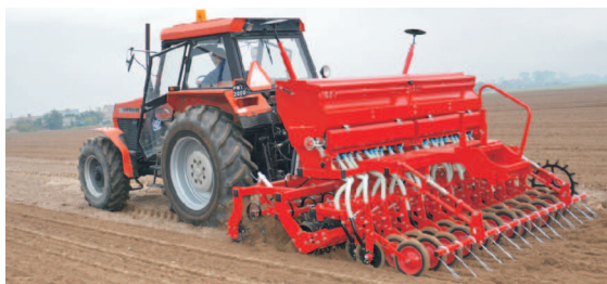
Rys. 4. Agregat uprawno-siewny z mechatronicznym układem sterowania
