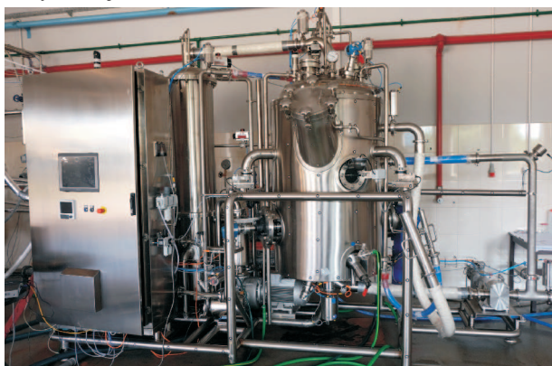
Rys. 5. Uniwersalny aparat próżniowy z funkcją odzysku aromatu
