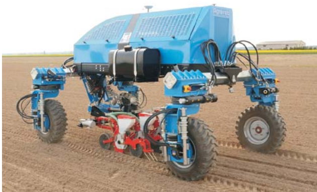
Rys. 2. Autonomiczny robot polowy z modulem do siewu podczas prób
