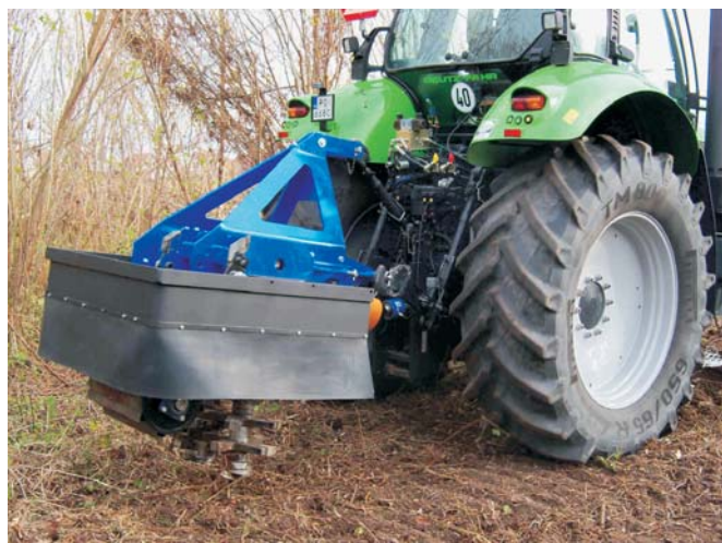
Rys. 5. Maszyna zagregowana z ciągnikiem rolniczym do rekultywacji pól po uprawie wierzby energetycznej i krzewach owocowych
