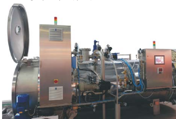
Rys. 7. Urządzenie do sterylizacji produktów spożywczych z kaskadowym systemem schładzania oraz zintegrowanym układem do wykorzystania ciepła poprocesowego Fig. 7. Device for sterilization of food products equipped with a cascading cooling system and an integrated system of post-processing heat usage
