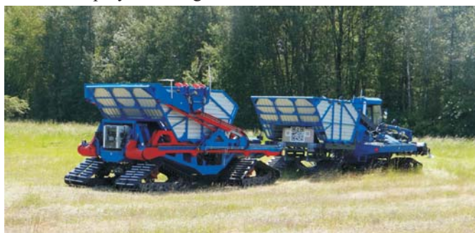
Rys. 9. Autonomiczny pojazd do transportu biomasy współpracujący z zespołem koszącym
