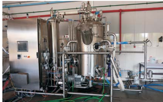
Rys. 11. Uniwersalny aparat próżniowy z funkcją odzysku aromatu
