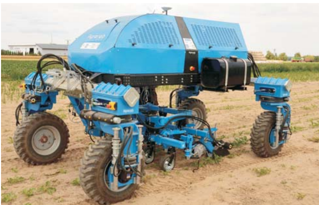
Rys. 3. Autonomiczny robot polowy z modulem do pielęgnacji upraw podczas prób
