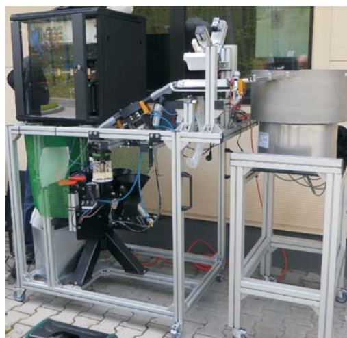
Rys. 10. Automat z systemem wizyjnym do skaryfikacji oraz oceny zdrowotności nasion dębu
