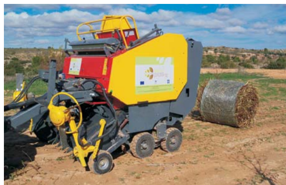
Rys. 4. Maszyna do zbierania i zwijania materiału drzewnego w sadach, w winnicach wg wynalazku PIMR
