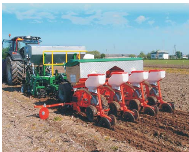
Rys. 8. Wieloczynnościowy agregat do pasowej uprawy gleby, nawożenia i siewu nasion
