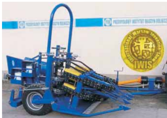
Rys. 5. Maszyna do zbioru, wiązania i układania snopów wikliny plecionkarskiej wg wynalazku PIMR oraz uzyskany Złoty Medal IWIS 2013
