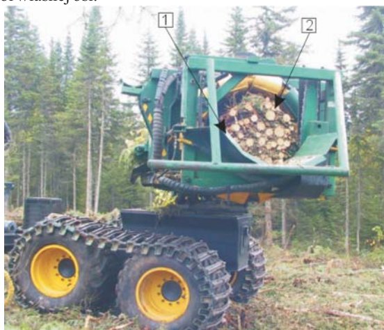
Rys. 3. Głowica pakietująca, uformowany pakiet (1), prowadnica z piłą łańcuchową (2) (fot. H. Różański) Fig. 3. The bundling head, with a ready formed bundle (1) and a chain-saw (2) (Photo by H. Różański)
