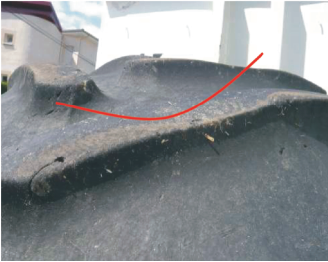
Rys. 4. Przykład nieregularnego zużycia bieżnika na skutek dociążenia osi przedniej wodą w oponach (badania własne) Fig. 4. An example of irregularly worn tyre caused by unnecessary hydroinflation (own research)
