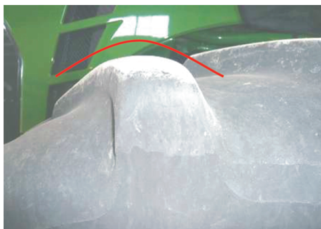
Rys. 3. Przykład nieregularnego zużycia bieżnika na skutek nieprawidłowego ciśnienia powietrza w ogumieniu (badania własne)
