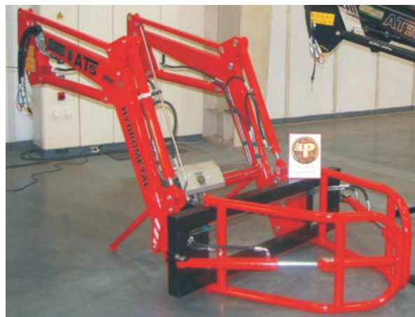
Rys. 3. Ładowacz czołowy serii AT produkcji firmy HYDROMETAL Tomasz Kowalewski, Ostrów Mazowiecka Fig. 3. AT Series - Front End Loaders manufactured by HYDROMETAL Tomasz Kowalewski, Ostrów Mazowiecka, Poland
