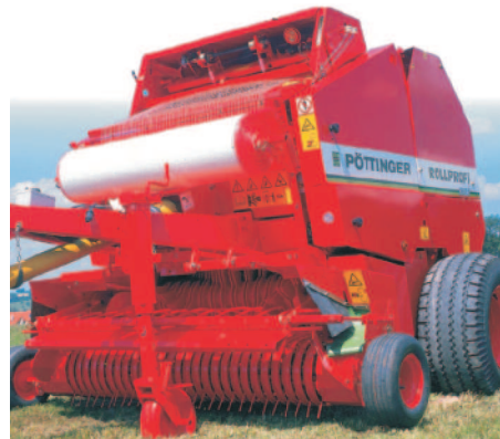
Rys. 3. Prasa zwijająca z zespołem rozdrabniającym Fig. 3. Round baler with a rotor cutter
