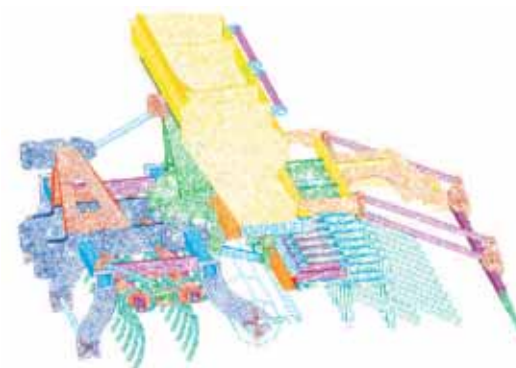
Rys. 2. Model agregatu uprawowo-siewnego zdyskretyzowany elementami płytowo-powłokowymi [3]
