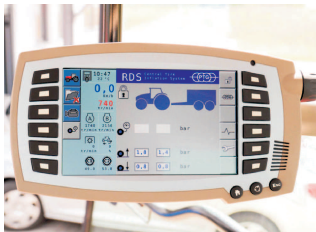
Rys. 7. Przykładowe rozwiązania interfejsu systemu CPK [2, 3, 5]
