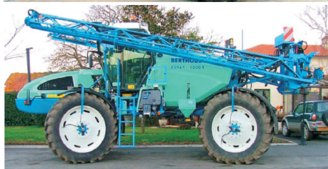
Rys. 5. Przykładowe rozwiązania automatycznego dwuprzewodowego układu CPK z doprowadzeniem powietrza do opony przewodem prowadzonym po zewnętrznej stronie koła [4]
