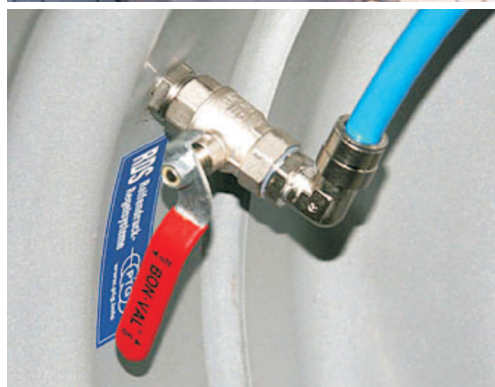
Rys. 2. Przyłączony do kół na postoju półautomatyczny układ CPK zamontowany na ciągniku rolniczym [2]
