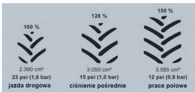
Rys. 1. Powierzchnia kontaktu opony radialnej z gruntem w zależności od ciśnienia powietrza w ogumieniu [2]
