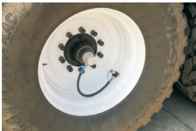
Rys. 3. Koło automatycznego dwuprzewodowego układu CPK z doprowadzeniem powietrza przez otwór w czopie wiercony osiowo [3]
