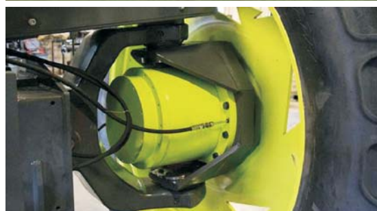
Rys. 2. Nośnik narzędzi Multi Tool Trac i silnik elektryczny koła [10]
