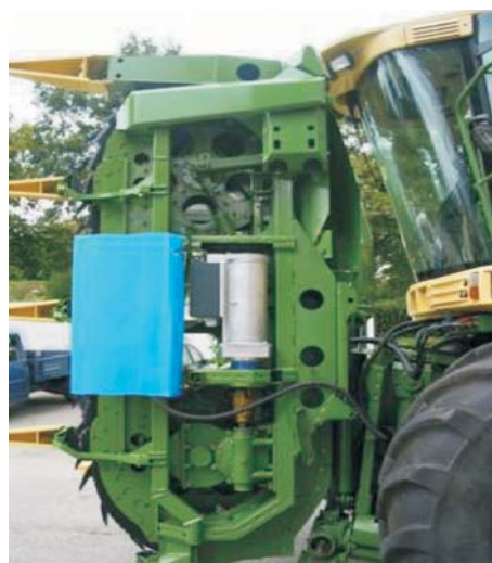
Rys. 6. Silnik elektryczny układu napędowego przyrządu tnącego prototypu siewkarni polowej Krone Big X [6] Fig. 6. Electric drive unit for header in a prototype self-propelled forage harvester Krone Big X [6]
