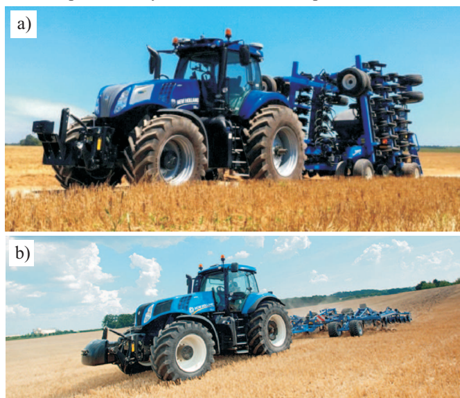
Rys. 1. Autonomiczny ciągnik rolniczy New Holland NH Drive podczas przejazdu transportowego (a) i w trakcie wykonywania zabiegu agrotechnicznego (b) [1]
