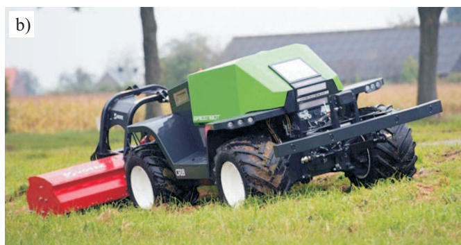
Rys. 4. Autonomiczny ciągnik Greenbot podczas przejazdu transportowego (a) i w trakcie wykonywania zabiegu agrotechnicznego (b) [1]
