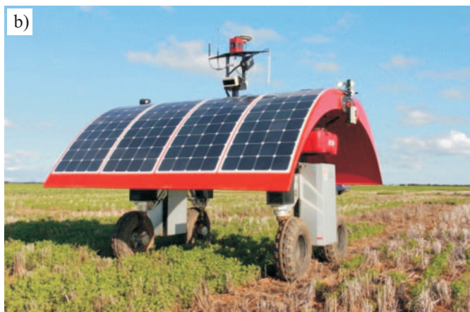
Rys. 7. Autonomiczny pojazd rolniczy Ladybird - panele fotowoltaiczne złożone (a) i rozłożone (b) [6, 8] Fig. 7. Ladybird autonomous vehicle - solar panels close (a) and open (b) [6, 8]
