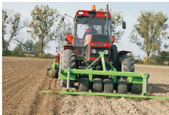
Rys. 6. Koła narzędzia przedniego, ciągnika i agregatu tylnego zagęszczają glebę na całej szerokości pasa siewnego Fig. 6. The wheels of front tool, tractor and rear unit thicken the soil over the entire width of the seed belt
