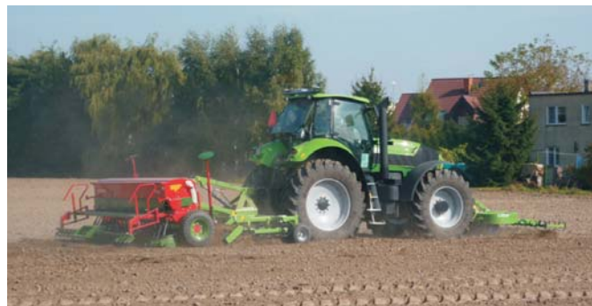
Rys. 5. Zestaw uprawowo-siewny z narzędziem przednim i agregatem tylnym Fig. 5. Tilling-and-sowing set with front tool and rear unit
