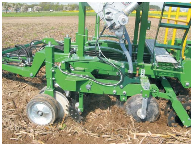
Źródło: opracowanie własne / Source: own work Rys. 8. Sekcja uprawiająca pasowo glebę i aplikująca nawóz Fig. 8. Section for strip cultivation and fertilizer application
