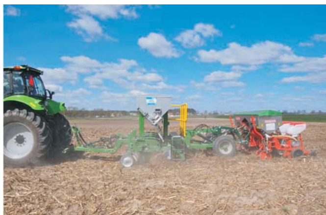
Źródło: opracowanie własne / Source: own work Rys. 7. Agregat do jednoczesnej pasowej uprawy gleby, nawożenia i siewu kukurydzy Fig. 7. Unit for simultaneous strip cultivation, fertilizing and corn seeding
