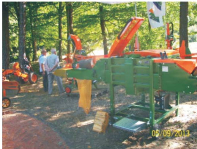
Rys. 2. Urządzenie do produkcji szczap rozpalających Fig. 2. Machine for production of fire splinters
