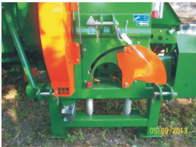
Rys. 1. Łuparka o podwójnej możliwości zasilania Fig. 1. Log splitter with dual power supply
