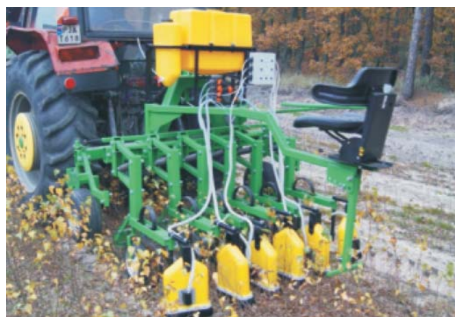
Rys. 10. Przystawka do oprysku głowicami wirującymi OS-W [2] Fig. 10. Attachment with rotating spray heads OS-W [2]
