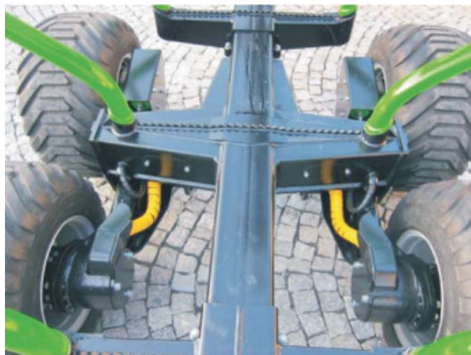
Rys. 4. Napęd hydrauliczny przyczep do zrywki drewna FAO-FAR [1] Fig. 4. Hydraulic drive of wood trailer FAO-FAR [1]
