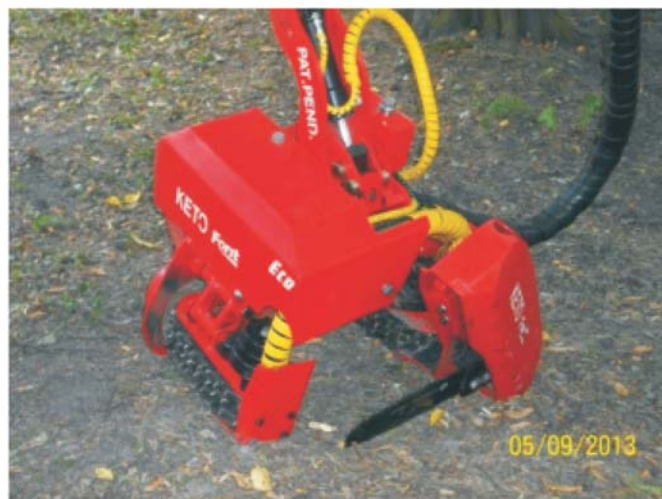
Rys. 5. Głowica harwestera zastosowana w maszynie MALWA [1] Fig. 5. Harvester head used in the MALWA machine
