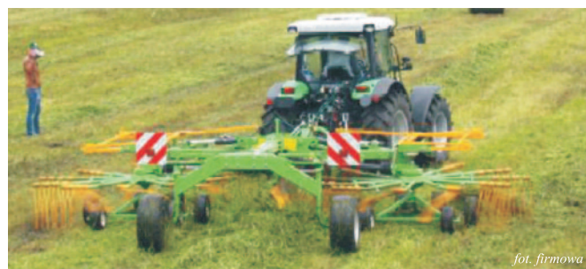
Rys. 7. Zgrabiarka dwukaruzelowa Z 2-780 produkowana przez firmę SaMASZ w Białymstoku
