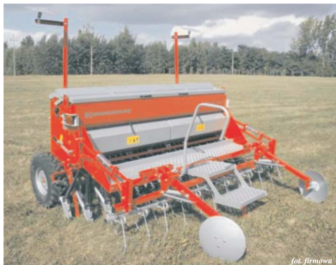
Rys. 2. Siewnik mechaniczny Kongskilde EcoLine produkowany przez Kongskilde Polska Sp. z o.o. w Kutnie Fig. 2. Kongskilde EcoLine Mechanical Seeder manufactured by Kongskilde Polska Sp. z o.o., Kutno (Poland)
