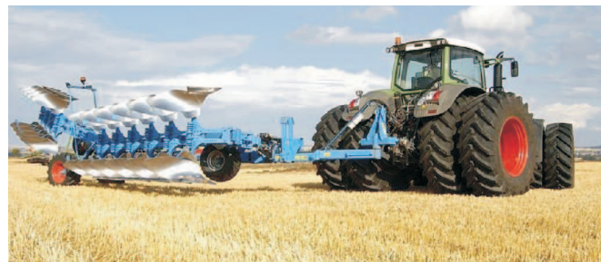
Rys. 1. Model EuroTitan pługa obracalnego półzawieszanego produkcji firmy Lemken [9]
