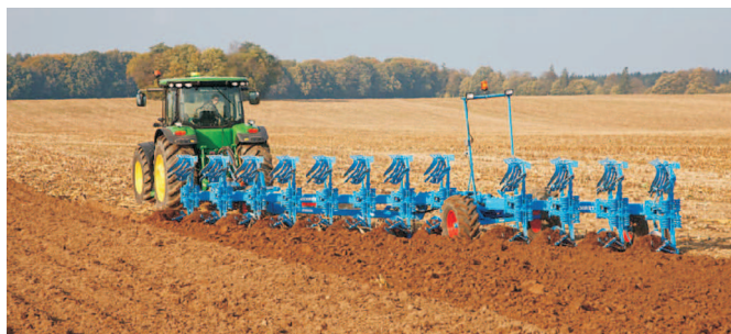
Rys. 2. Model VariTitan pługa obracalnego półzawieszanego produkcji firmy Lemken [9]
