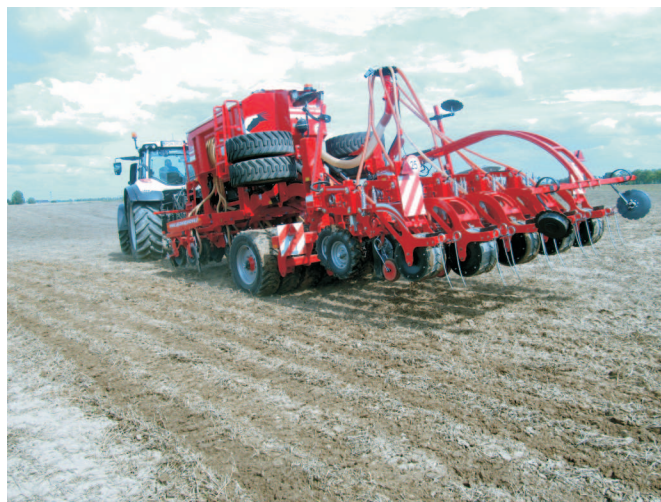
Rys. 3. Uniwersalny agregat uprawowo-siewny z przystawką do wysiewu zbóż (fot. T. Piechota)
