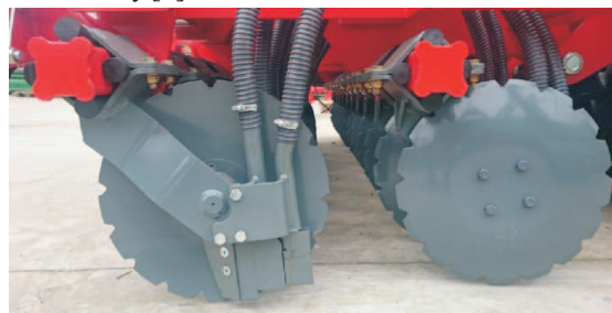
Rys. 7. Redlica jednotarczowa (Unia) wysiewająca nawóz i nasiona w jeden rowek [8] Fig. 7. The single disc coulter (Unia) seeding fertilizer and seeds in one row [8]
