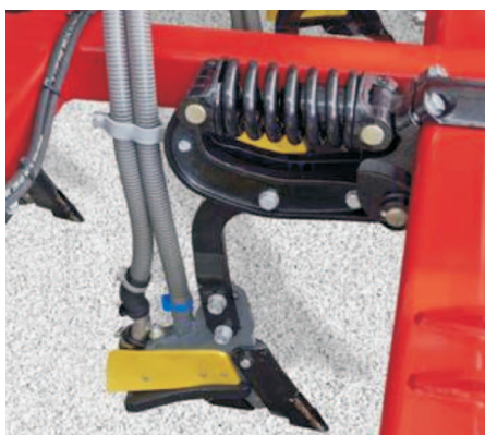
Rys. 9. Redlica zębowa (Horsch) wysiewająca 1 rząd nawozu i 2 rzędy nasion
