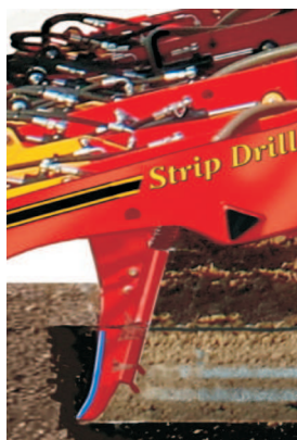
Rys. 3. Ząb spulchniający glebę i aplikujący nawóz na dwóch głębokościach (Vaderstad) [9] Fig. 3. Tine for softening soil and fertilizer dispensing at two depths [9]
