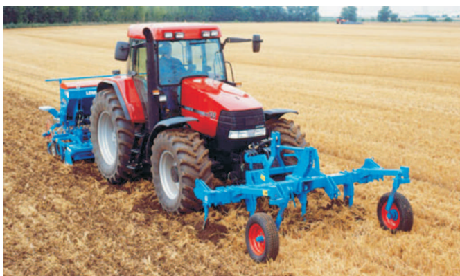
Rys. 8. Uprawa bezorkowa kultywATOREM przednim i agregatem uprawowo-siewnym na bazie brony wirnikowej [9]
