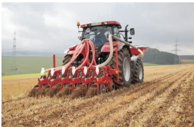
Rys. 12. Uprawa pasowa i nawożenie wglębne [8] Fig. 12. Strip-till and subsoil fertilization [8]
