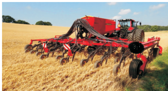
Rys. 10. Siew bezpośredni w ściernisko siewnikiem wyposażonym w redlice dłutowe [11]
