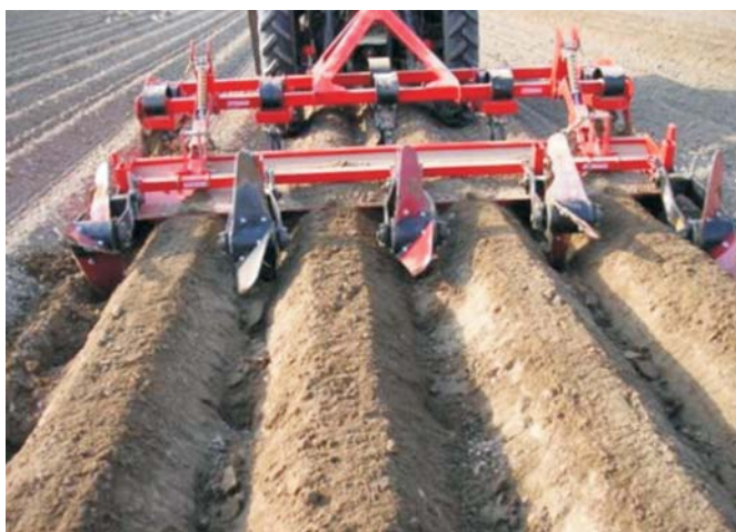
Rys. 9. Żłobienie dolków między redlinami [14]
