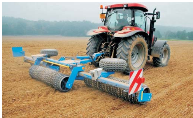
Rys. 4. Wałowanie posiewne wałem Cambridge [13]
