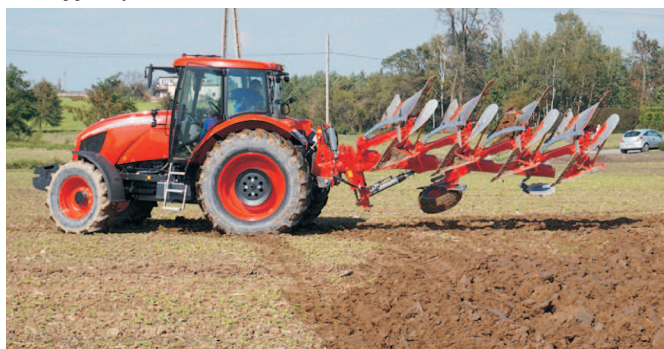
Źródło: opracowanie własne / Source: own work Rys. 4. Obrót pługa na uwrociu Fig. 4. Rotation of the plough on the headland
