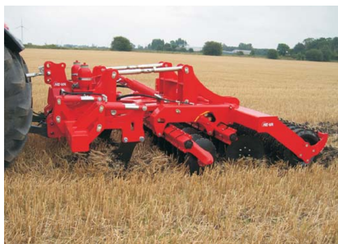
Rys. 8. Głębosz 2-rzędowy (HE-VA) z broną talerzową i wałem [11] Fig. 8. Double-row subsoiler (HE-VA) with disc harrow and shaft [11]
