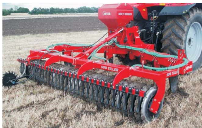
Rys. 13. Głębosz (HE-VA) z wałem i siewnikiem [13] Fig. 13. Subsoiler (HE-VA) with shaft and seed drill [13]
