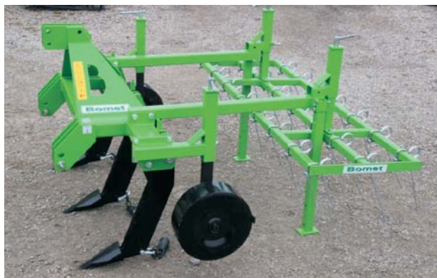
Rys. 11. Głębosz 1-rzędowy (BOMET) ze zgrzeblem [7] Fig. 11. One-row subsoiler (BOMET) with a scraper [7]
