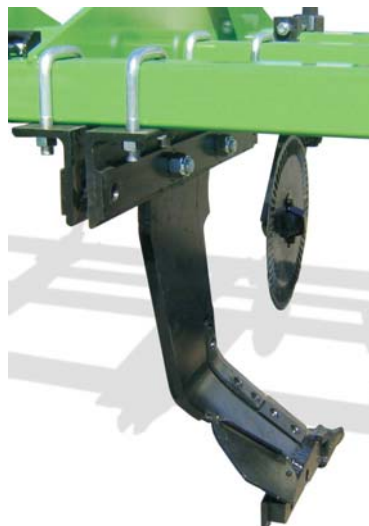
Rys. 4. Ząb zakrzywiony skośnie w bok [8] Fig. 4. Tooth obliquely curved side [8]
