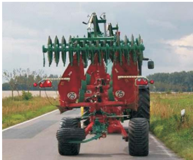
Rys. 8. Wał Packomat w położeniu transportowym [14]
