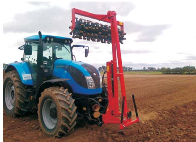
Rys. 15. Wał przedni Omega W (POM Brodnica) w położeniu transportowym [16] Fig. 15. Omega W front roller (POM Brodnica) in the transport position [16]
