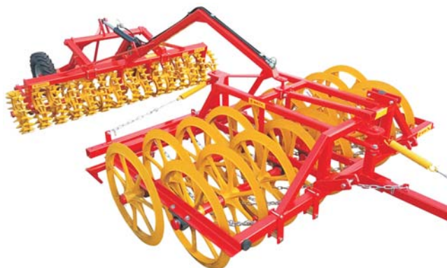
Rys. 4. Podwójny wał Campbella z wałem Crosskill (Brix) wyposażonym w koła [8]
