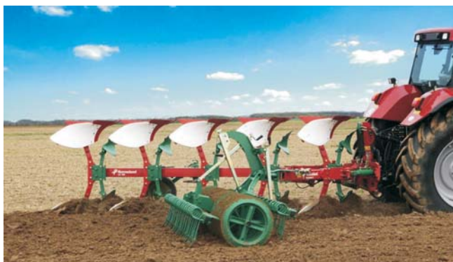
Rys. 7. Wał Packomat (Kverneland) zintegrowany z pługiem [14]
