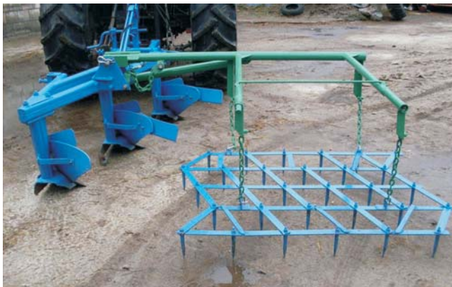
Rys. 5. Brona zębowa zintegrowana z pługiem zagonowym za pomocą nośnika [6]
