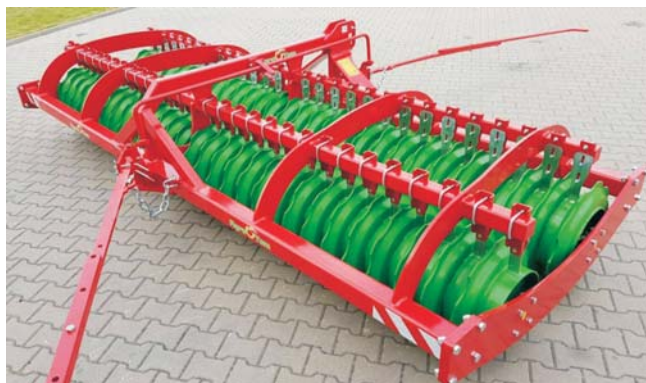
Rys. 2. Wał doprawiający przyczepiany do pługa obracalnego (Agro-Tom) [7]
