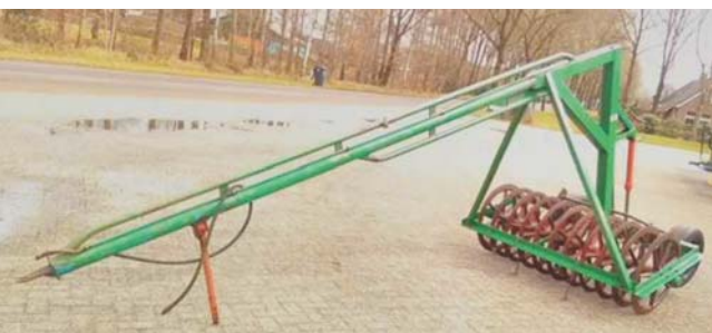
Rys. 13. Wózekz wałem Campbella (Zibo) [17] Fig. 13. Trolley with the Campbell roller (Zibo) [17]
