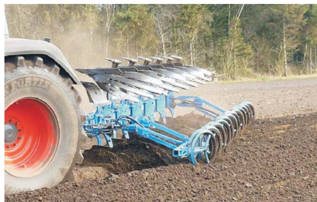
Rys. 9. Wał FlexPack (Lemken) zintegrowany z pługiem [15]
