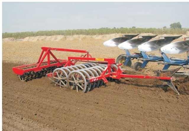
Rys. 3. Podwójny wał Campbella z wałem Crosskill (Expom Krośniewice) [9]
