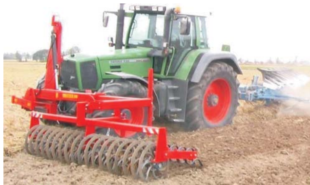
Rys. 14. Wał przedni Terra (Expom Krośniewice) [13] Fig. 14. Terra front roller (Expom Krośniewice) [13]
