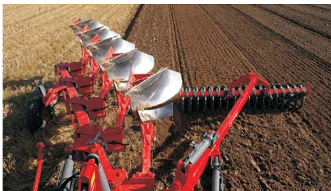
Rys. 6. Wał Terra H (Unia Grudziądz) zintegrowany z pługiem [18]
