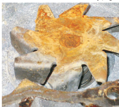
Rys. 6. Rdza na łopatkach wirnika pompy wodnej, uniemożliwiająca pompie sprawne rozprowadzanie płynu chłodzącego
