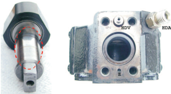
Rys. 7. Statystyka uszkodzeń elementów pompy wtryskowej Common Rail typu CP4 stosowanej w ciągnikach rolniczych Fig. 7. Statistics of damages to the elements of CR injection pump, type CP4 used in agricultural tractors
