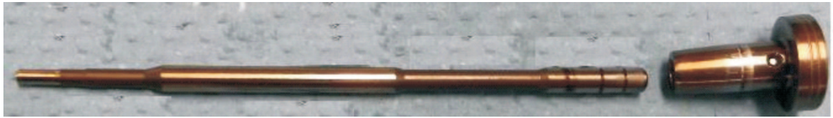
Rys. 18. Zawór iglicowy wtryskiwacza Common Rail BOSCH; widoczny żółtawy nalot ma związek ze stosowaniem biopaliw oraz działaniem kwasów organicznych zawartych w paliwie
