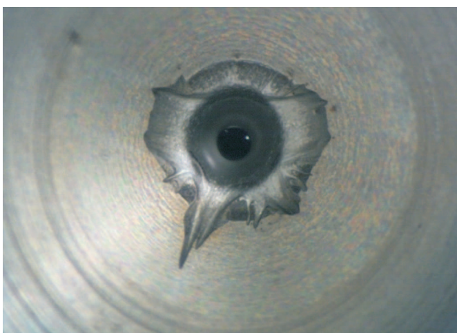
Rys. 15. Uszkodzenie gniazda zaworu sterującego (Common Rail-Bosch)
