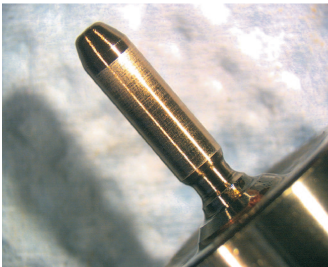
Rys. 19. Zużycie tarciowo-korozyjne tłoczka zaworu sterującego oraz popychacza iglicy (Common Rail)
