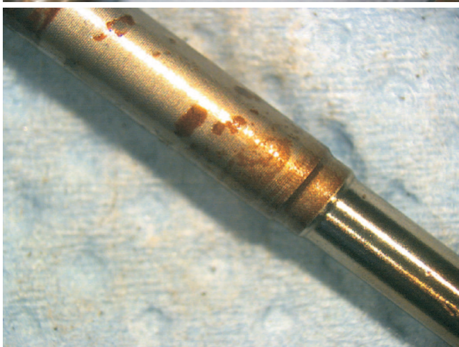
Rys. 17. Wżery korozyjne na rozpylaczu wtryskiwacza i iglicy pod wpływem siarki i wody
