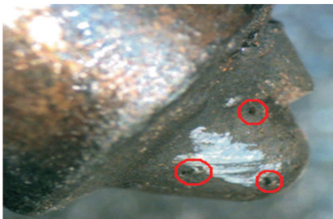
Rys. 14. Przegrzanie i zmiana struktur końcówki (rozpylacz Common Rail-Bosch)
