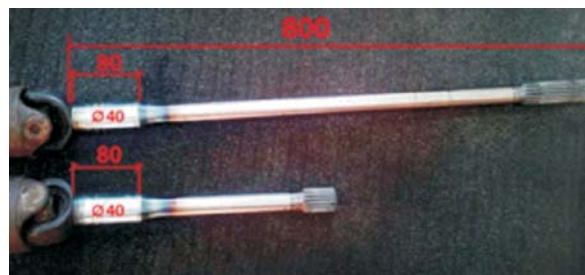
Rys. 3. Regeneracja metodą metalizacji natryskowej wałów Cardana
