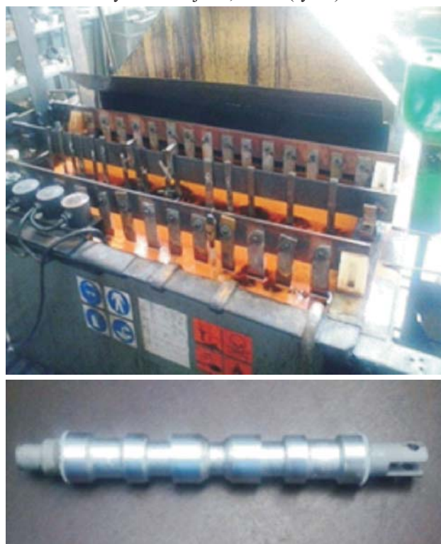
Rys. 5. Przebieg procesu regeneracji przez chromowanie - widok wanny elektrolitycznej oraz suwaka rozdzielacza po zabiegu
