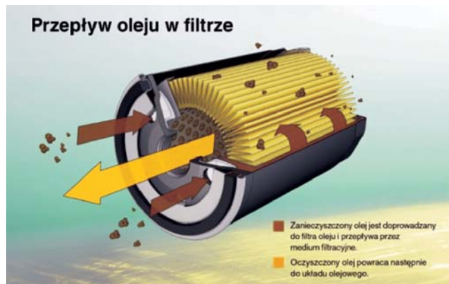
Rys. 2. Filtr pełnoprzepływowy stosowany w silnikach ciągników rolniczych [8]
