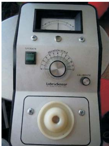
Rys. 6. Urządzenie LUBRI SENSOR NI-2B do wyznaczenia przenikalności elektrycznej oleju silnikowego [14]
