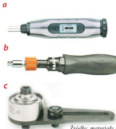
Rys. 6. Wkrętaki dynamometryczne i wzmacniacze Bahco: a) wkrętak o zakresie 1-5 Nm, b) wkrętak TSS600 o zakresie do 5 Nm, c) wzmacniacz standardowy Bahco o zakresie 340-1700 Nm
