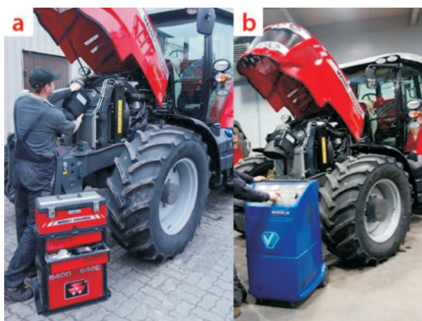
Rys. 9. Serwisowanie ciągników rolniczych Massey Ferguson: a) zestaw serwisowy Massey Ferguson, b) automatyczna stacja do napełniania klimatyzacji
