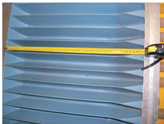
Rys. 1. Widok niewłaściwego stołu rowkowego (źr. PIMR) Fig. 1. View of the wrong patternator. (source PIMR)
