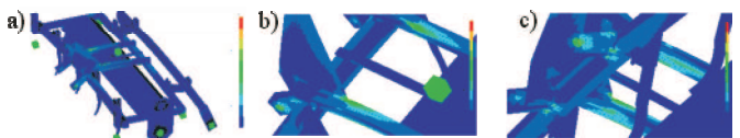
Rys. 2. Przypadek LC1 - transport, mapa naprężeń zredukowanych - widok ogólny (zielone kostki reprezentują masy skupione przyłożone do siatki elementów skończonych)
