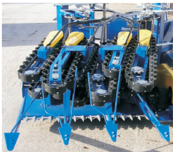
Rys. 6. Wieloczynnościowa maszyna do zbioru wikliny - widok z przodu
