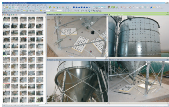
Rys. 2. Interfejs programu PhotoModeler Scanner ze zdjęciami silosu
