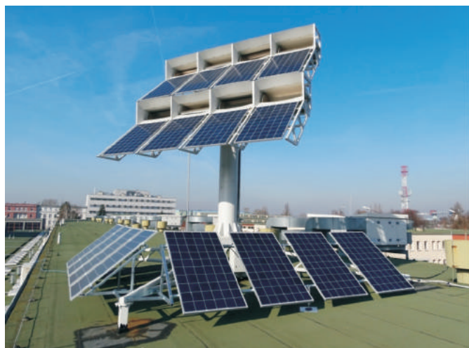
Rys. 1. Uniwersalne stanowisko badawcze urządzeń do pozyskiwania energii ze źródeł odnawialnych (OZE) zlokalizowane na dachu budynku "H" PIMR
