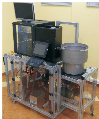
Rys. 1. Automat z systemem wizyjnym do skaryfikacji oraz oceny zdrowotności nasion dębu
