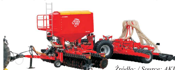
Rys. 3. Agregat uprawowo-siewny o dużej szerokości roboczej do przedsięwzięcia uprawy gleby i jednoczesnego wysiewu nasion Fig. 3. The aggregate of large working width for pre-treatment of soil and simultaneous seeds sowing
